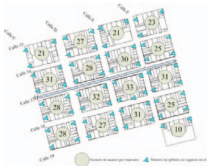
Figura 4. Distribución de splitters de segundo nivel.
