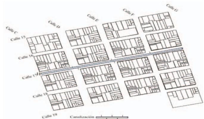
Figura 2. Distribución de predios y servicios en una red FTTH.
